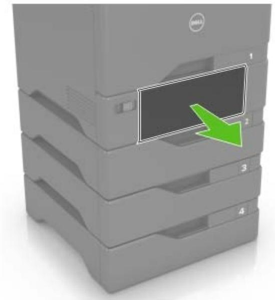
**Attention — Dommages potentiels :** Un capteur dans le tiroir facultatif peut facilement être endommagé par l'électricité statique. Touchez une surface métallique avant de retirer le papier coincé dans le tiroir.
